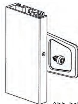
Der DEFLEX-Kedergriff kann bei Bedarf mit der Schraube 2067 gesichert werden.
