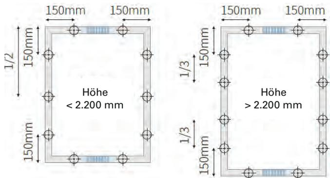
**■** = Sperrkorridore: Durch innenliegende Magnete, dürfen in den markierten Bereichen keine Bohrungen eingebracht werden.
