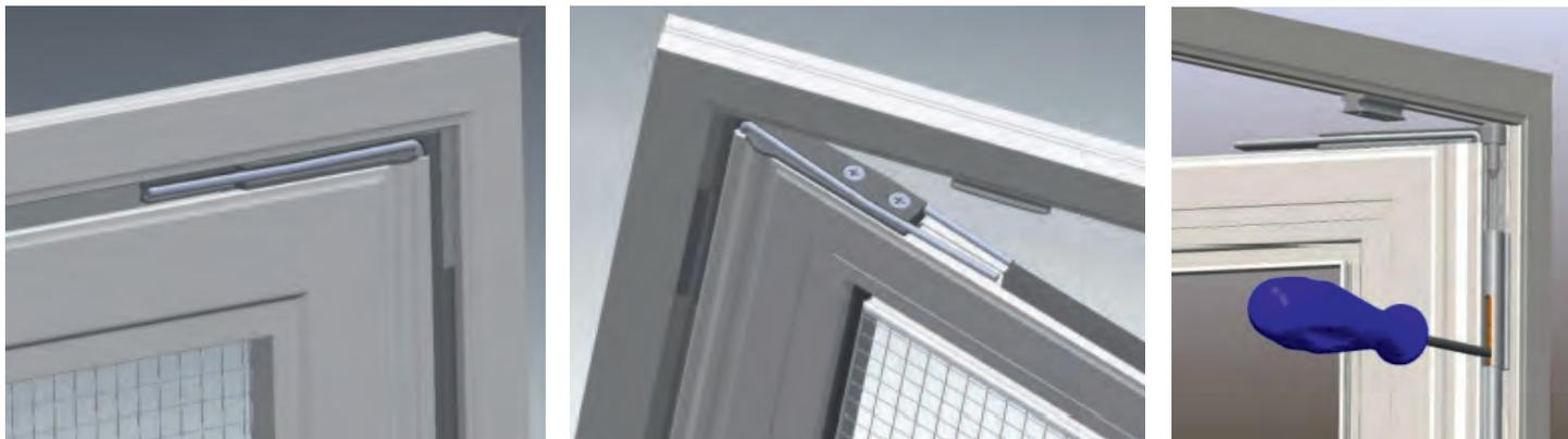
Zum Ver- oder Entriegeln des oberen Scharniers und der mittleren Scharniere sollte generell der mitgelieferte Spezialschlüssel verwendet werden. Alternativ kann auch ein Innensechskantschlüssel SW2 oder Torx TX8 verwendet werden.
