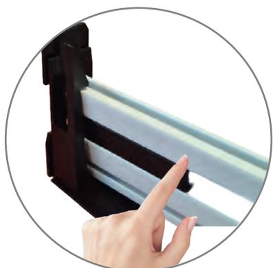
4. Verriegelung der Endschiene erfolgt automatisch durch Kippen beim Herunterdrücken (Endschiene verriegelt unter den Zapfen der Führungsschieneinsätze).
