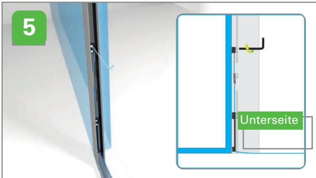
Den Magneten aus dem Anschlagprofil lösen. Die dahinter liegenden Fadenspanner auf leichte Spannung bringen.
