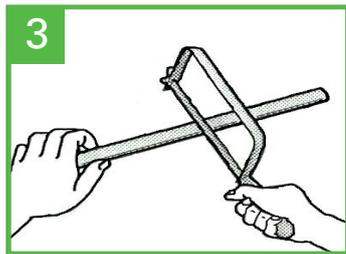
3 Schneiden Sie die untere Führungsleiste auf Breite der Laibung.
