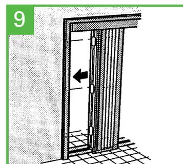
9 Entfernen Sie die Schutzfolien der Verankerungsclipse der Kassette und pressen Sie danach die Kassette fest und gerade gegen die Laibung.
