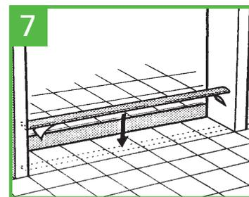
7 Entfernen Sie die Schutzfolie vom Klebestreifen der unteren Führungsleiste und positionieren Sie diese in Übereinstimmung mit der oberen Führungsschiene.
