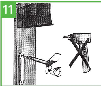
Befestigen Sie die Verankerungsclipse mit Schrauben. Benutzen Sie dabei einen Schraubendreher und keinen Elektroschrauber!
