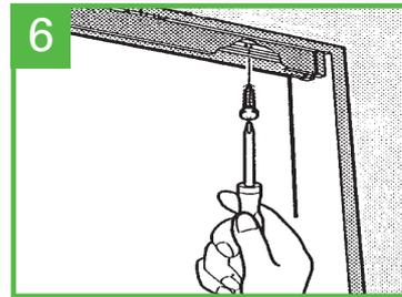
6 Schrauben Sie die obere Führungsschiene fest.
