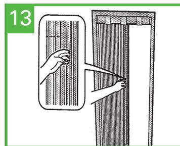
Greifen Sie das bewegliche Element der Kassette ungefähr in der Mitte und ziehen Sie es seitlich, um das DEFLEX-Plisseesystem zu öffnen und zu schließen.
