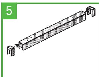
5 Stecken Sie beide Kappen in die obere Führungsschiene.
