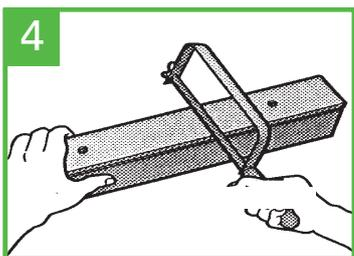
4 Schneiden Sie die obere Führungsschiene auf Breite der Laibung.
