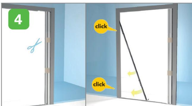
Das Anschlagprofil von dem Schiebepprofil lösen und in das gegenüberliegende Seitenprofil einklippen.
